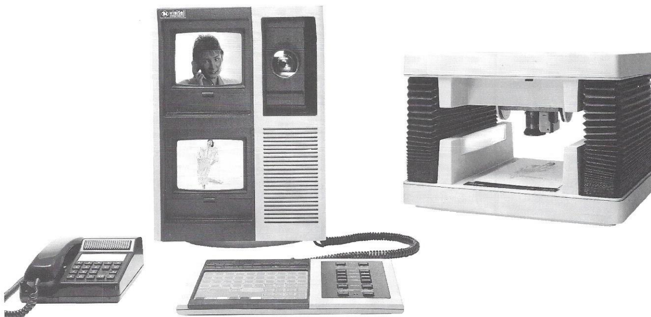
Das VISITEL-Terminal, bestehend aus Videoturm, Kamerastation, Bedientableau und Fernsprecher
